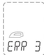
Wärmeplatte über 270 °C ± 15 °C
